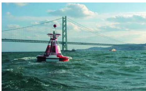
Slika 4: Svetleća bova u Akaši prolazu sa plimskim generatorom i svetionik Micunokošima koji koristi kombinaciju energije talasa i solarnu energiju
