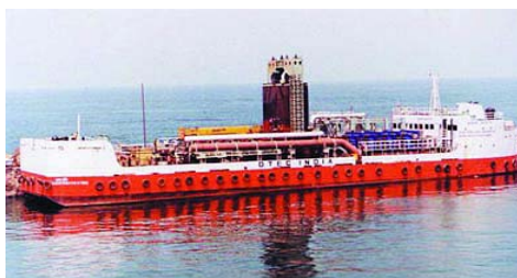
Slika 8: Brod koji testira OTEC 15 sistem u Indijskom okeanu
