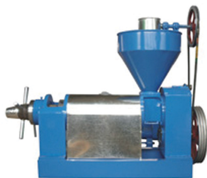
Слика 3. Механичка преса за маслодајни семиња - YZS-95 Oil Press(7.5kw)
