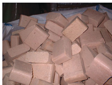
Сл. 4.2.18. Призматичен облик на брикети изработени од струганицы од дрво
