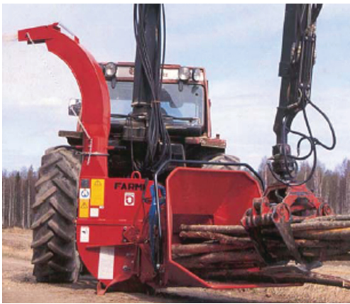
Сл. 4.1.1. Мобилни дробилки на отпадно дрво погонувани со земјоделски трактори со рачно и механичко полнење
