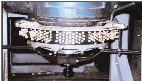
Сл. 4.2.13. Машина за производство на пелети со вертикален калап
