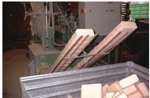
Сл. 4.2.7. Машина за брикетирање на брикети со призматичен облик
