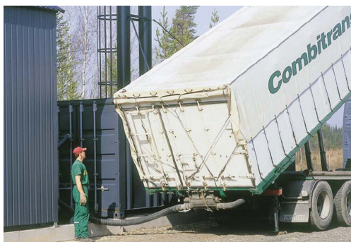
Сл. 4.2.21. Пневматски начин на претоварање на пелети од камион со церада во бункер – силос за складирање
