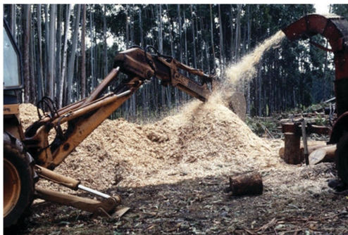
Сл. 3.2.8. Дробење и мелење на дрвените отпадоци на местото на сечење во шумата
