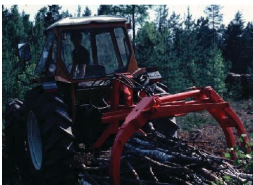
Сл. 3.2.3. Трактор со хидраулична корпа за влечење дрвени отпадоци
