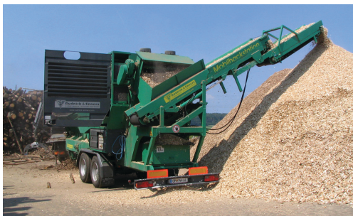
Сл. 4.1.2. Мобилни дробилки на отпадно дрво на претоварно складиште
