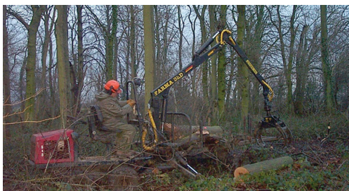
Сл. 3.2.6. Минијатурна машина за собирање и влечење на дрвените отпадоци
