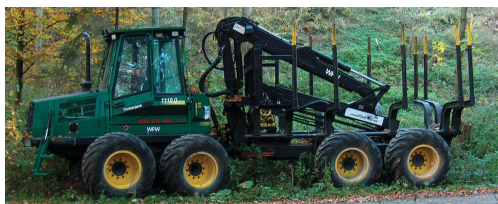
Сл. 3.2.5. Возило за транспорт со хидраулична корпа за товаране дрвени отпадоци, монтирана на хидрауличен столб зад кабината
