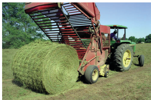
Сл. 3.1.5. Балирање на тревести растенија во цилиндрична бала
