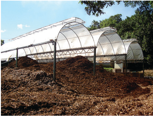
Сл. 3.2.14. Сушење и складирање на дрвените отпадоци во вид на иверки во близина на постројка за брикетирање
