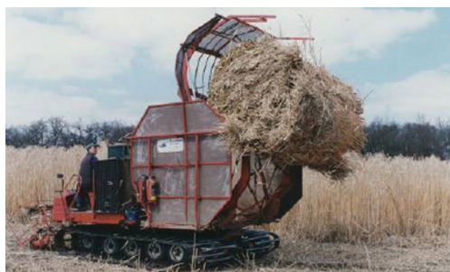
Сл. 3.1.3. Подвижна машина за врзување во снопови на тревести растенија во вид на стебла
