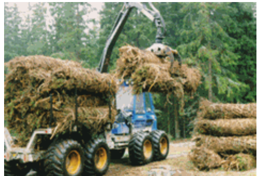
Сл. 3.2.11. Транспортирање на врзаните снопови од дрвени отпадоци од местото на сечење во шумата до шумските пристапни патишта
