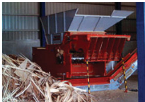
Сл. 4.2.2. Машини за дробење со бункер за прифаќање на суровиот материјал, производ на „Wiema“
