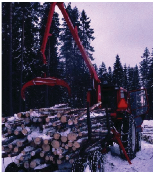
Сл. 3.2.4. Транспорт на исечените дрва со трактор со приколка
