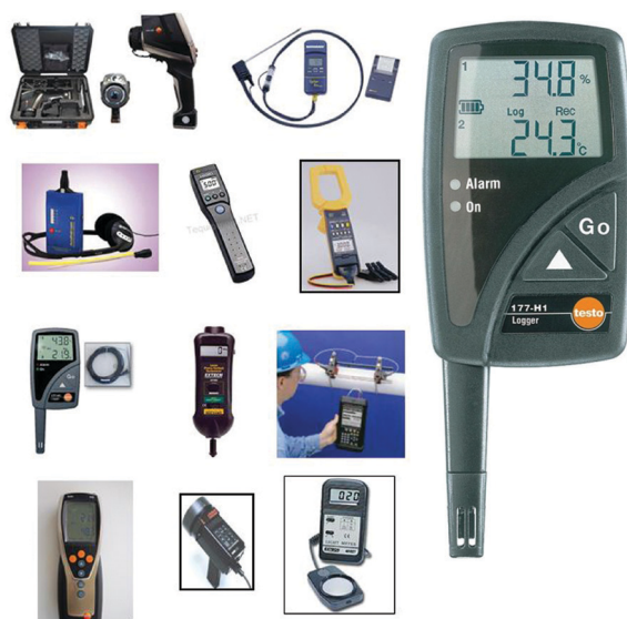
Слика 27. Инструменти што се користат при вршење на енергетски прегледи
